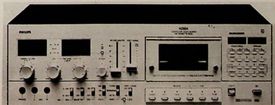
Bild 1. Der Hi-Fi-Stereo-Cassetten-Recorder N 2554 (Erstauslieferung an den Handel: Okt. 79) ist mit einem Computer-codierten Suchlauf (CCS) für das Aufsuchen und Abspielen beliebiger Bandstellen ausgestattet (Philips)
